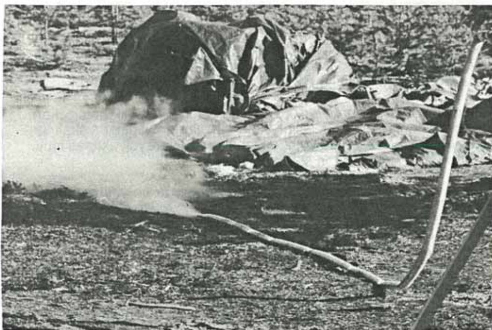
Försök med flytande klor genom brandslang
