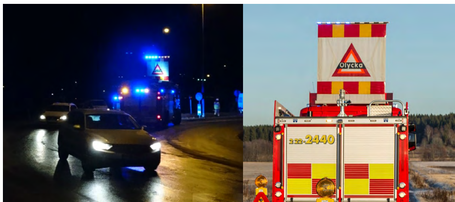
Bild 10. Exempel på takskylt med vägmärke X6 och markeringsskärm X2. Foto högra bilden: David Hårseth
