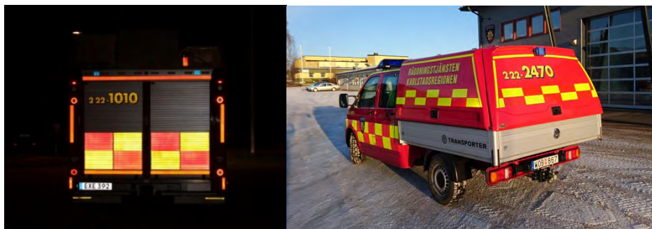
Bild 9. Exempel på Battenburgmönster på utryckningsfordon.
