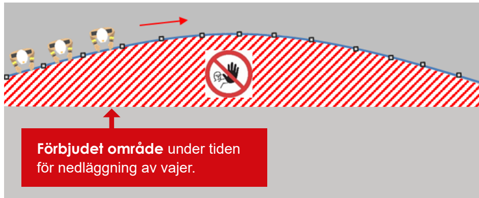
Figur 11. Nedläggning av vajer ska endast ske från ett håll. Notera att det är förenat med mycket stora risker att befinna sig i området inne i kurvan. Detta område bör därför ses som förbjudet område att vistas inom samtidigt som nedläggning av vajer pågår (röd/vit-randigt område i figuren).
