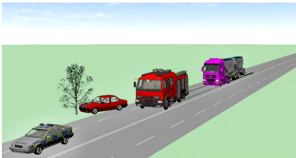
Bild 12. Exempel från simulering som visar hur påkört skyddsfordon kan förflyttas enligt krockberäkningar som genomförts särskilt för denna vägledning. Bromsspåren bakom utryckningsfordonet visar förflyttningen.
