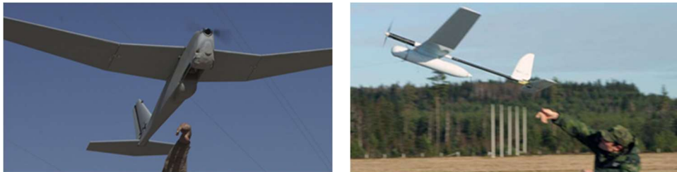
Figur 3. Två exempel på små obemannade luftfartyg med fasta vingar, som kastas i samband med start
