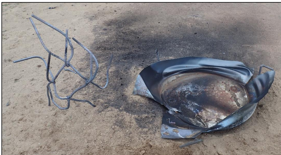
Figur 16: Ställning och plåtfat efter explosion av aluminiumflaska.
