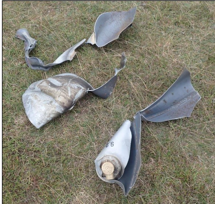
Figur 18: Ihopsamlade delar av stålflaskan.
