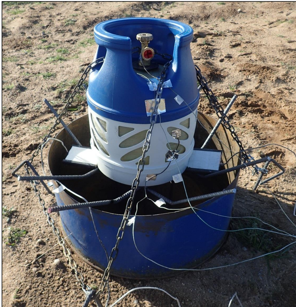
Figur 4: Försöksuppställning med fat, termoelement, plattermoelement, flaska samt förankring (kätting och jordspett). Utloppsventil vinklades i respektive försök för bästa visuella resultat.
