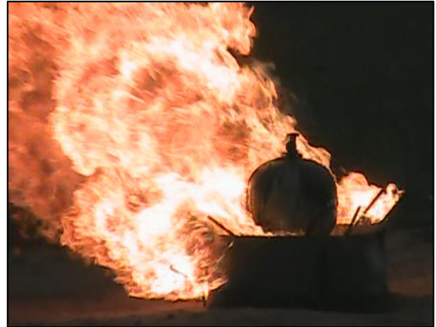
Figur 22: Flaskan kan antas ha varit flamutsatt på halva den omslutande ytan och vindkyld på andra halvan. Bild till höger från försök 5.
