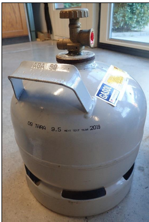
Figur 11: Flaska av stål, med säkerhetsventil.
