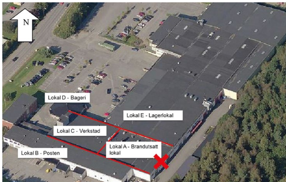
Figur B 8. Översiktsbild på industrihotellet. Krysset visar var branden startade och linjerna visar brandteknisk avskiljning. Bild: flygfoto från maps.google.se, hämtat 2014-05-15.
