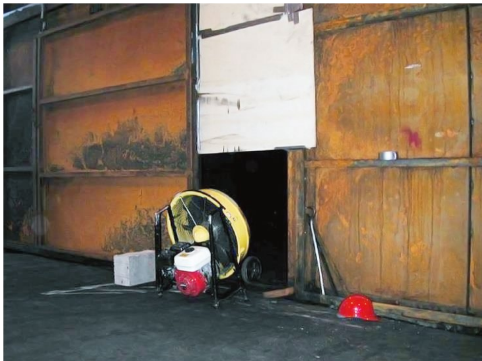
Figur B 22. Försök med dörr som är delvis täckt. Öppningen är 0,9 m x 1,03 m.
