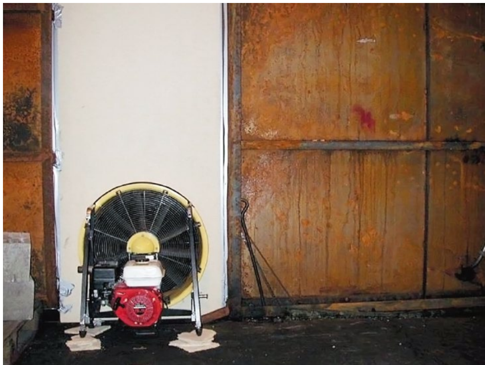
Figur B 23. En fläkt placerade i en öppning som motsvarade fläktens kåpdiameter, 0.6 m.
