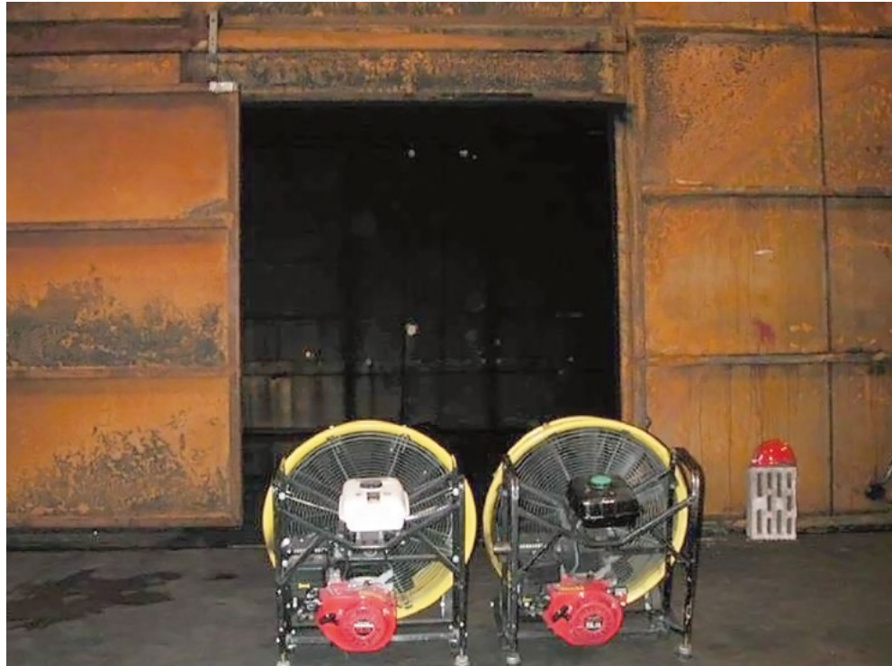
Figur B 24. Parallella fläktar framför porten till stålhuset.
