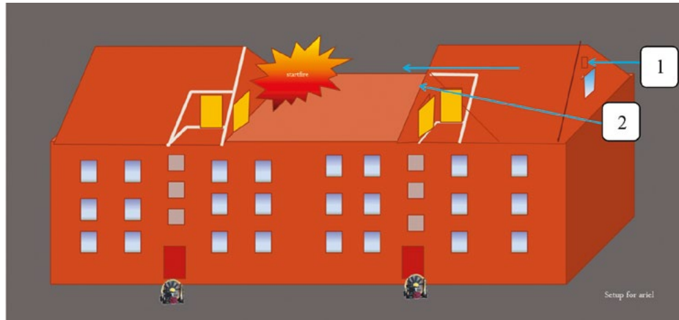
Figur B 6. Angreppspunkter med skärsläckare. Första försöket genom gavelspetsen av huset och andra försöket strax ovanför trapphus 1. Bild: Krister Palmqvist (SÄRF).
