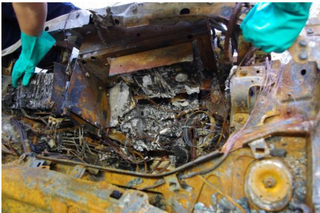
Bild 9 Fordonets motorrum var fullständigt utbränt och alla aluminiumkomponenter smälta eller förtärda av branden.
