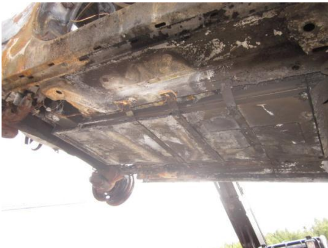
Bild 10 Batteriet är i stort sett intakt under bilen.
