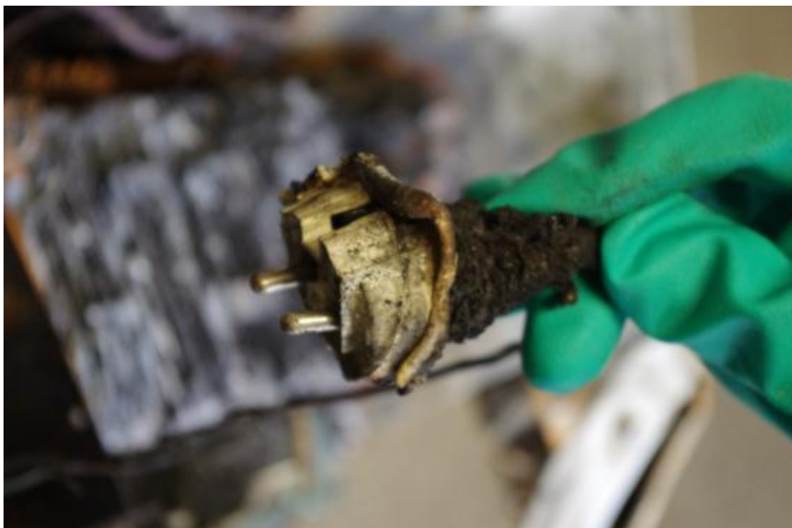
Bild 7 Stickpropp, har varit ansluten till vägguttag
