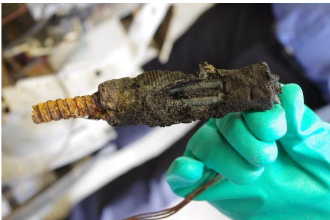
Bild 8 Laddintag av motorvärmartyp har varit ansluten, med andra ord har fordonet stått på laddning.
