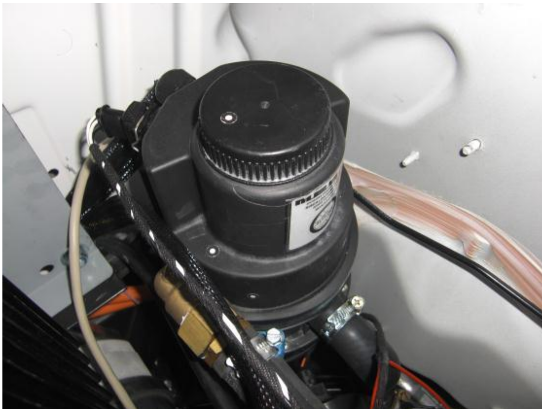
Bild 15 Kupévärmaren innan brand består av en värmeslinga som kan drivas av traktionsbatteriet (2000 W mellan 70 till 150 Vdc) värmaren kan startas under laddning.
