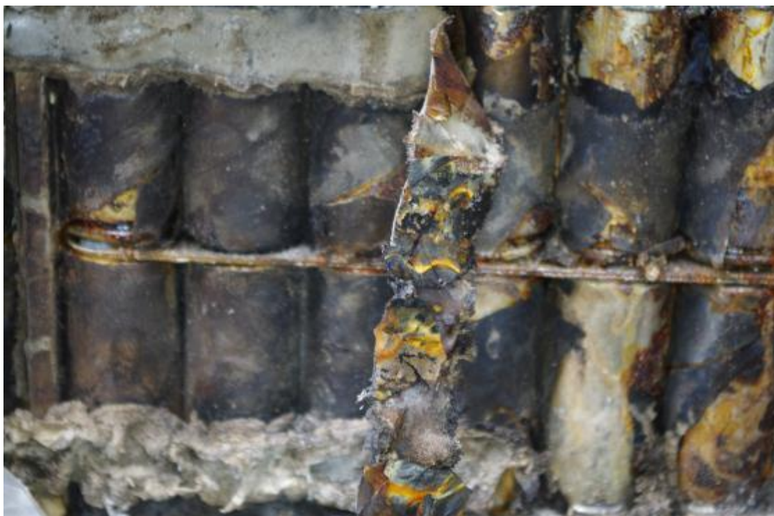
Bild 13 Närbild på cellpaketet underifrån efter att ha skurit upp ett hål i batteriet under fordonet med vinkelslip.
