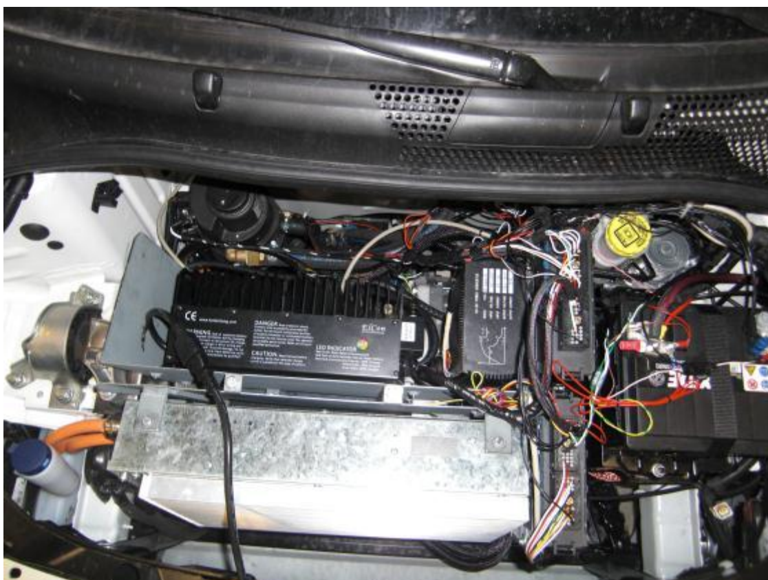
Bild 3 Drivsysteminstallation under motorhuv.
