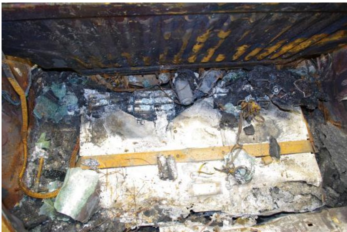
Bild 12 Batteriet i reservhjulbaljan är heller inte allt för skadat
