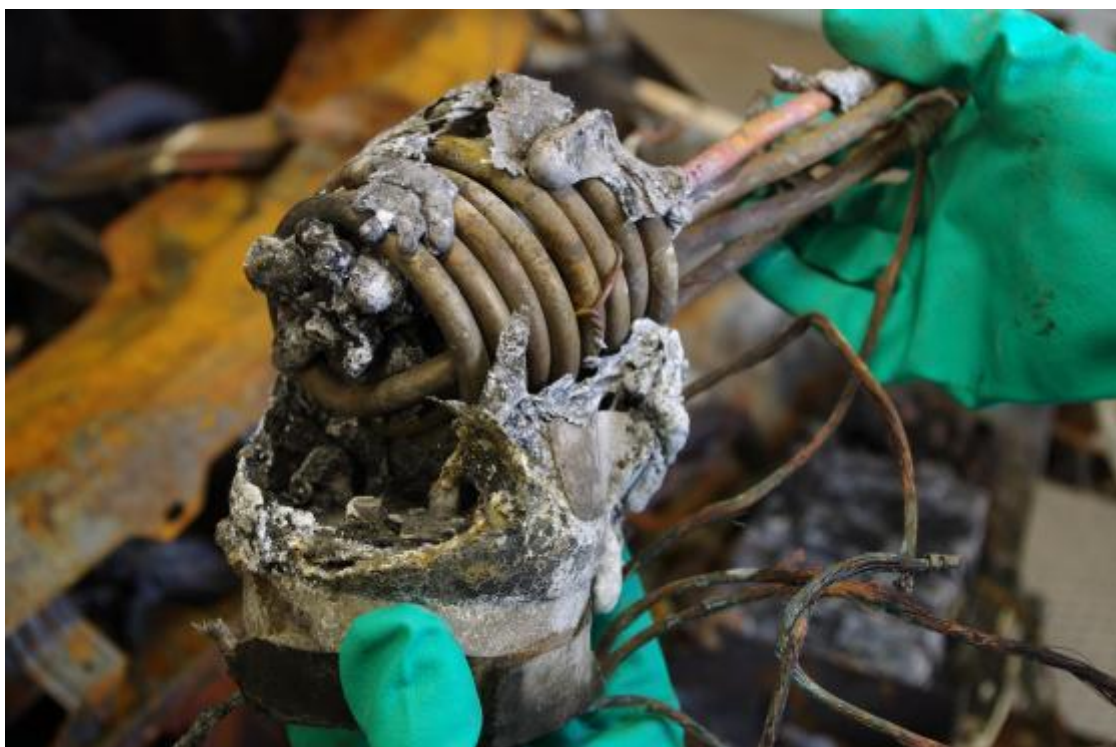
Bild 16 Kupévärmaren hade utsatts för sådan värme att endast värmeelementet var strukturellt intakt.
