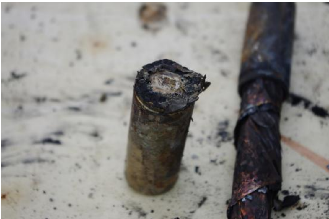
Bild 14 Cell som öppnat säkerhetsventil, i bakgrund ses cell med ruptur.
