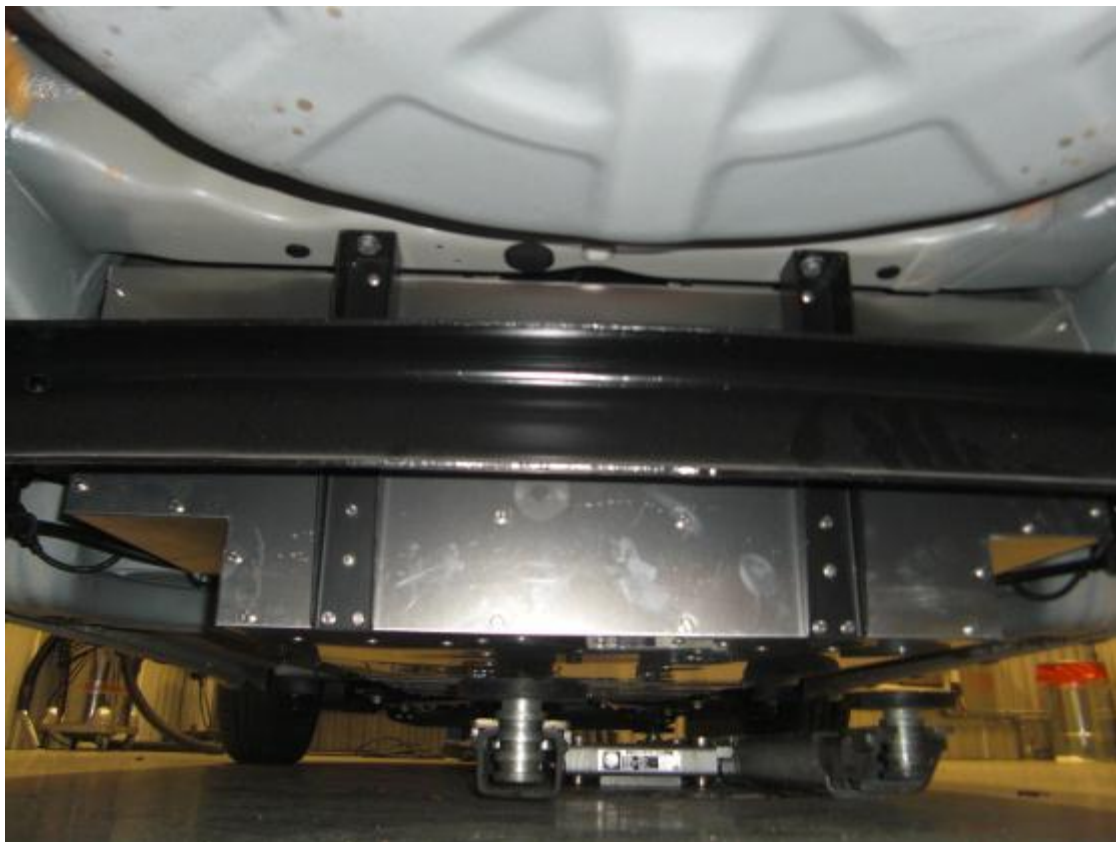
Bild 2 på batteripaket under bilen, lägg märke till att markfrigången minskats troligen ca: 40 mm , vilket kan ge räddningstjänst visuell information om att det är ett E-fordon.
