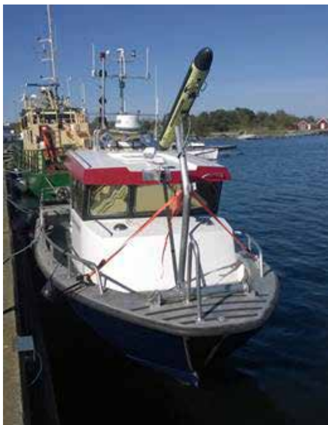
Sjöfartsverkets mindre enhet Petter Gedda som deltar i Grunda vatten projektet. Här utrustad med bland annat akustiskt sjömätningssystem i uppfällt läge (Klein 5000V2-Bathy).
