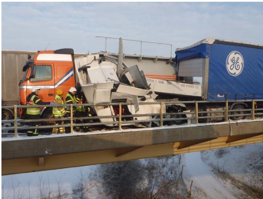
Foto 8: Mosad lastbilshytt, betongelement förflyttats från släpet (Foto: Helsingborgs brandförsvär)
