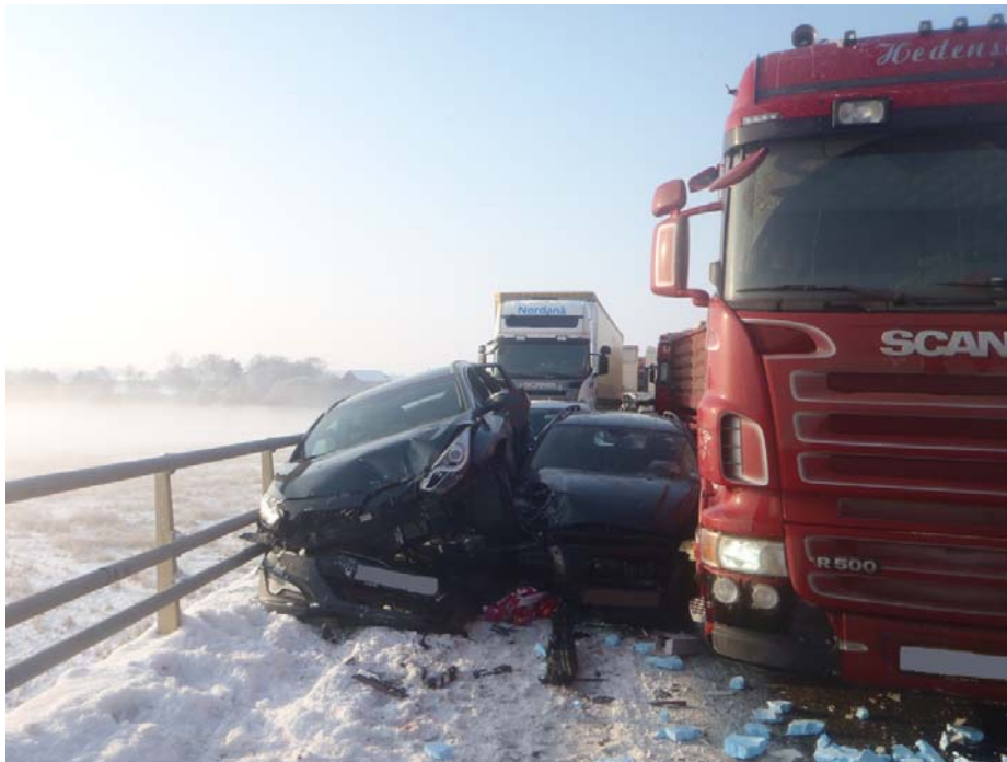
Foto 13: Personbilar klämda mellan räcke och lastbil (Foto: Helsingborgs brandförsvär)
