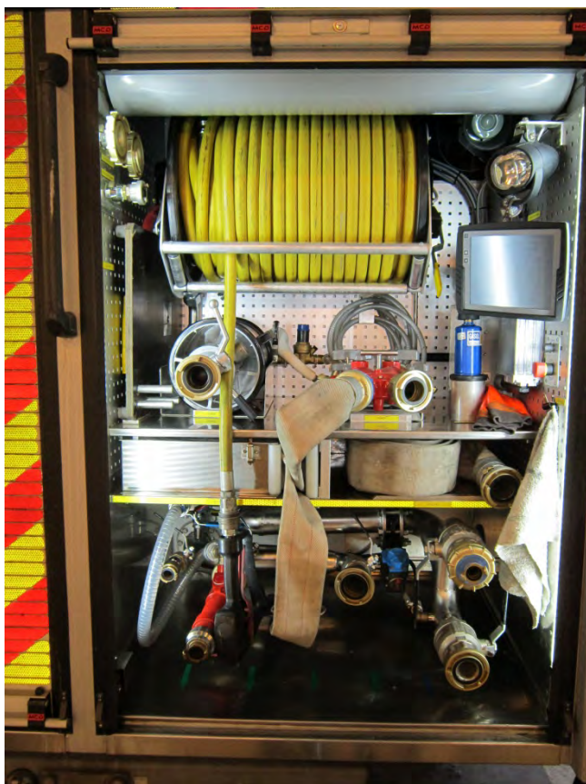
Figur 2 Centrumrulle med formstuv slang. (Foto: Peder Lindström, Räddningstjänsten Storgöteborg).
