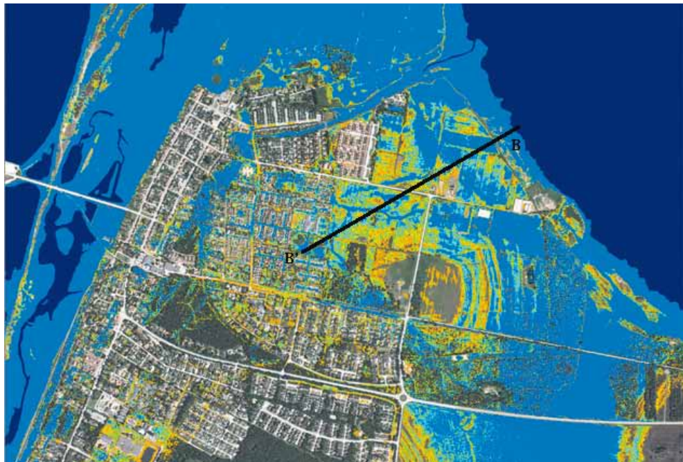
Bilden visar hur Skanör skulle drabbas av ett vattenstånd som motsvarar 50 års återkomsttid (ur projektet NNH och havsnivåhöjningar).
