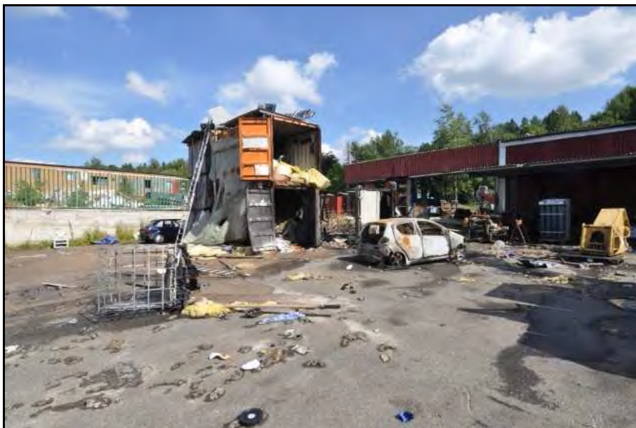
Bild 2: Tillverkningscontainern, den utbrända bilen (t.h.) och stålramen runt den IBC som stod utanför containern (A i Figur 3). I den övre tillverkningscontainern syns gult isoleringsmaterial av stenullstyp (inte brännbart).
