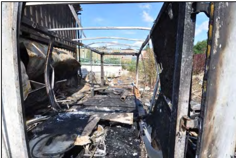
Bild 8: Förrådscontainern sedd från ena kortsidan. Stålramen har tydligt bågnat utåt åt alla håll.
