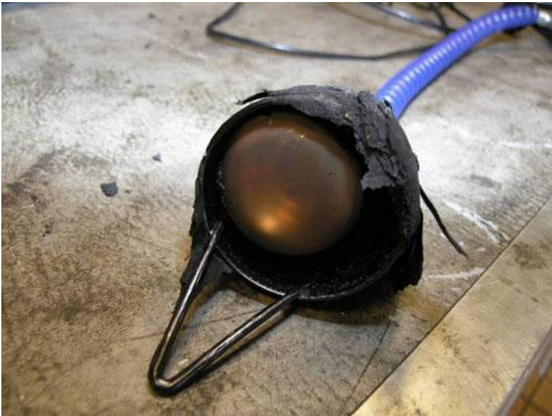
Runt lampskärmen av plåt syns sotiga tygrester som har fastnat på grund av värmen
