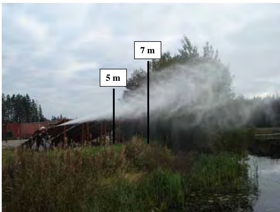
Bild 16 Demonstrationsförsök på övningsfältet vid Guttasjön i Borås visar hur strålen först bryts upp efter ca. 5 m. för att vara helt uppbruten vid ca. 7 m.
