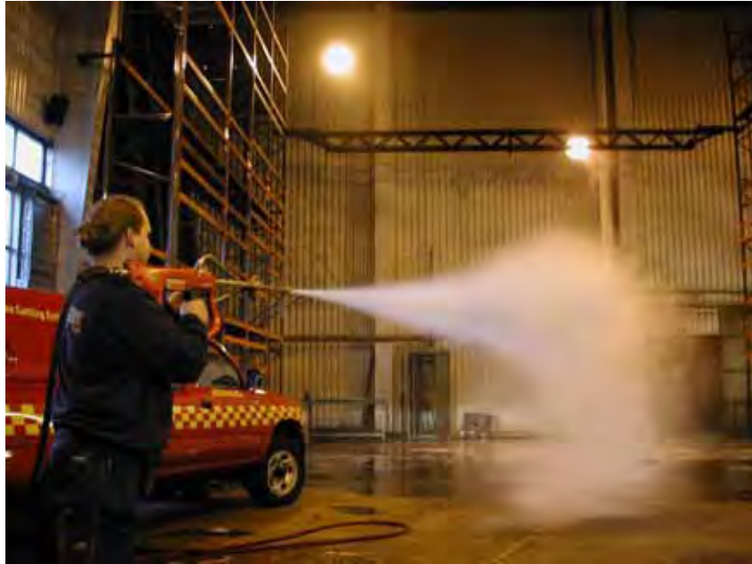
Bild 15 Försök med skärsläckarlansen för att utröna inverkan av tillsatsmedel på strålens uppbrott och kastlängd.
