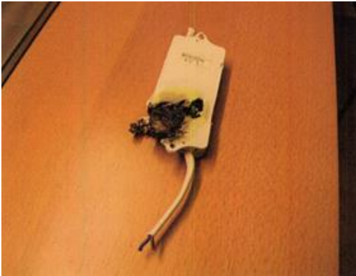
Det har även brunnit på baksidan. Detta orsakade brandskadan i skåpet
