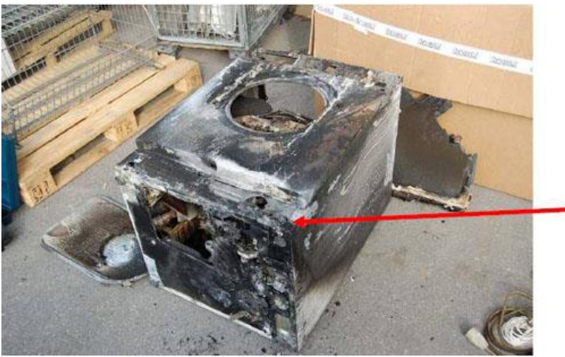
Bild 5. Visar tvättmaskinen framifrån och under. Pilen visar på pumpanordningens placering.
