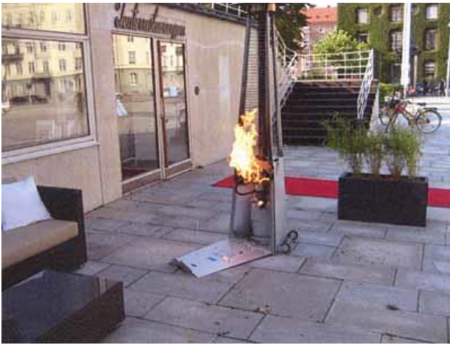
Styrenheten har smält och runnit ner på gasolflaskan
