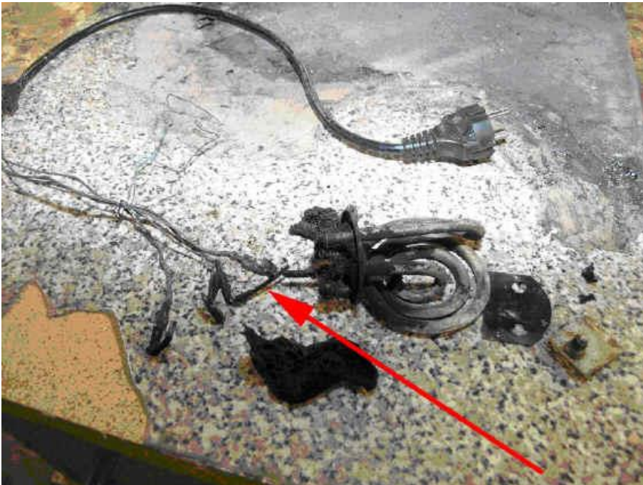
Resterna av vattenkokaren. Det är mycket troligt att branden har orsakats av något fel vid anslutningen mellan sladden och vattenkokaren.
