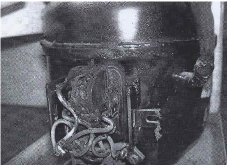
Bild 1. Bilden visar brandskadorna på startreläet.
