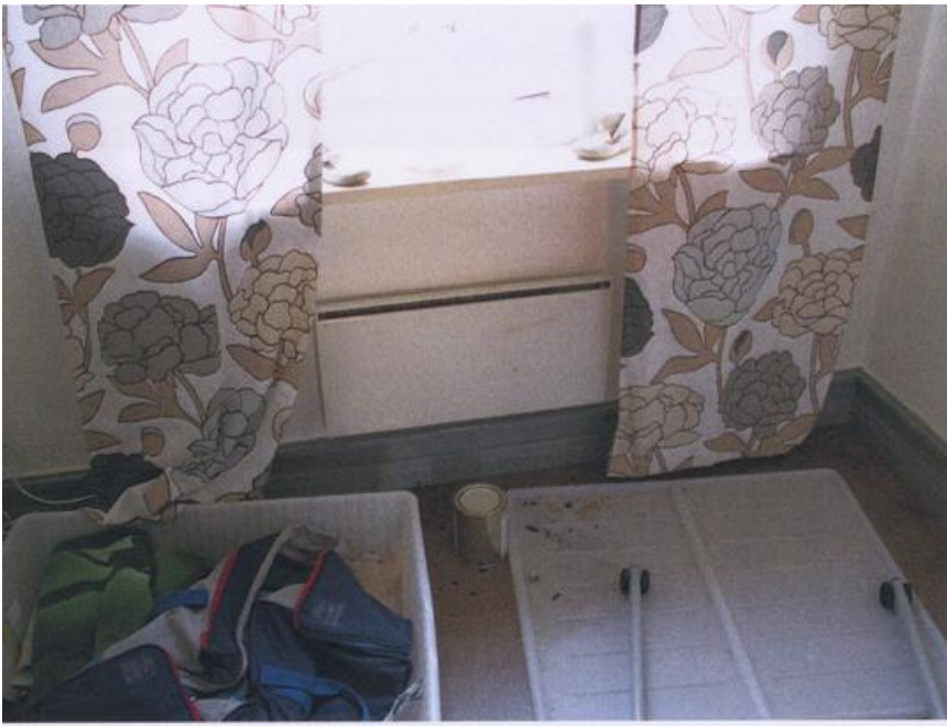
Bild 1. El-radiator som startade branden.
