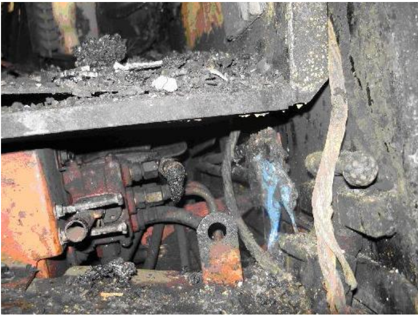
Till höger syns den klämskadade elkabeln som är brandstarten. Till vänster om kabeln finns laddningshandsken som inte har med brandenstarten att göra.
