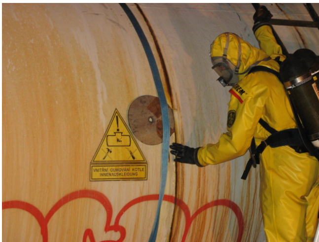
Bild 2.4 – Arbetet pågår med att täta den läckande vagnen.
