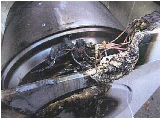
Resterna av reglagen som är ihopsmälta. I övre högra hörnet syns styrenheten den är oskadd.
