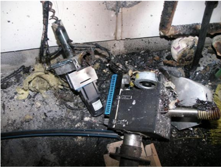
Matningsmaskinen (till vänster) och brännaren (till höger) med rester av skruven och dess plasthölje
