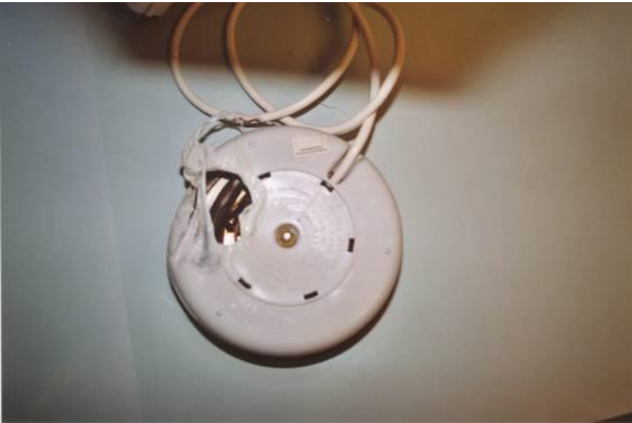
Äggkokaren har skador på undersidan.
