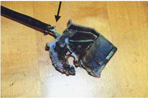
Brandskador på kontakten, en ledare har gått av utanför plasthöljet (se pil).
