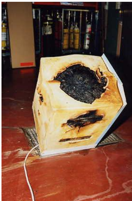
Genombränning i isoleringsmaterialet.
