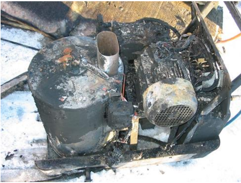
Den brandskadade tvätten.
