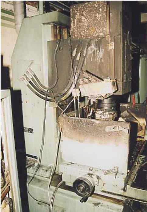
Maskinens vänstra sida, på tornet syns hållarna för gränslägesbrytaren, vilken varit korrekt inställd.
