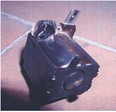
Spolen som har kraftiga skador där kablarna suttit.
