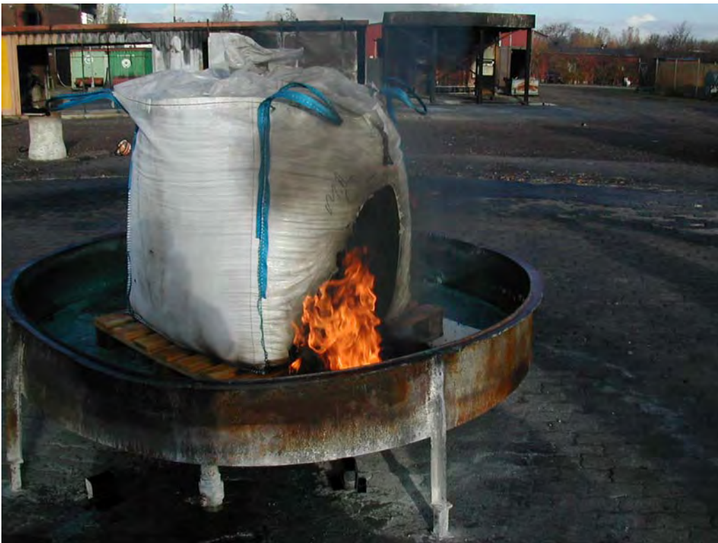
Bild 2 Efter ca 15 sekunder. Säcken fattar eld mycket fort och spricker upp. Granulat rinner ut...
