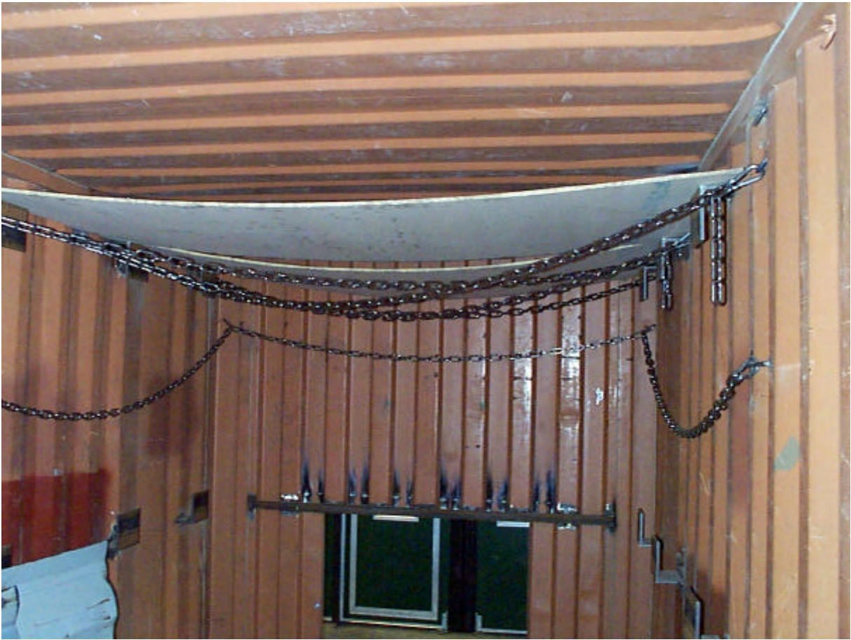
Upphängningsanordning med konsoler, kätting och karbinhakar.
