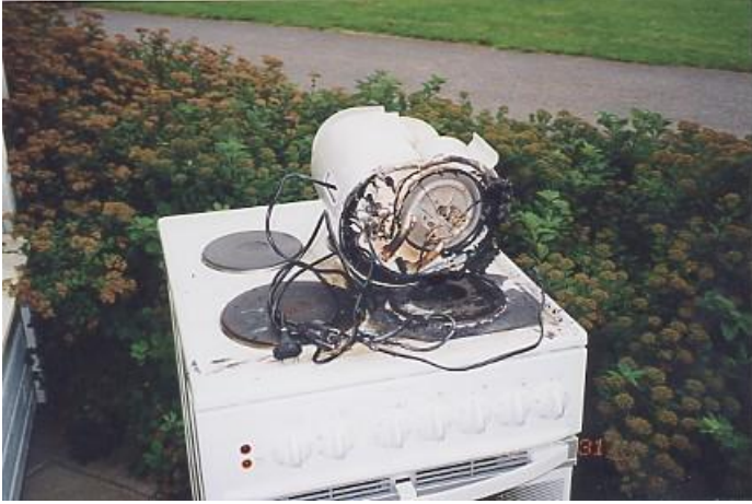
Kaffebryggare har erhållit kraftiga smältskador av den varma spisplattan.
