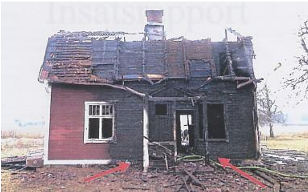
Bilden visar den norra sidan med brandresterna av farstukvisten. På denna sida av fastigheten finns anmärkningsvärt låga brandbilder på båda sidor om farstukvisten.
