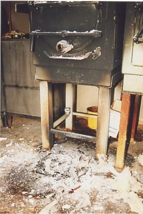
Rester från primärbranden, typisk soffana på destillatorn visar att branden utvecklats från golvet.
