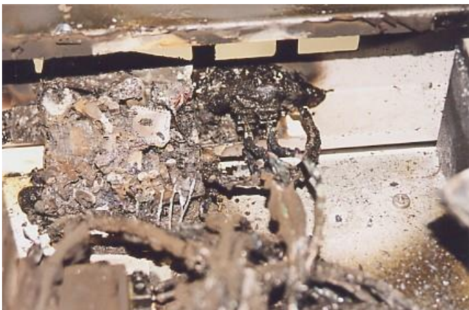
Styrenhetens innehåll sedan locket lyfts bort, innehåller kretskort med mikroprocessor m.m.
