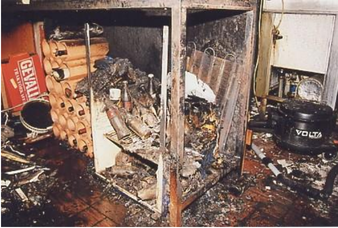
Kylskåp med rester av flaskor, primärbrandplats.
