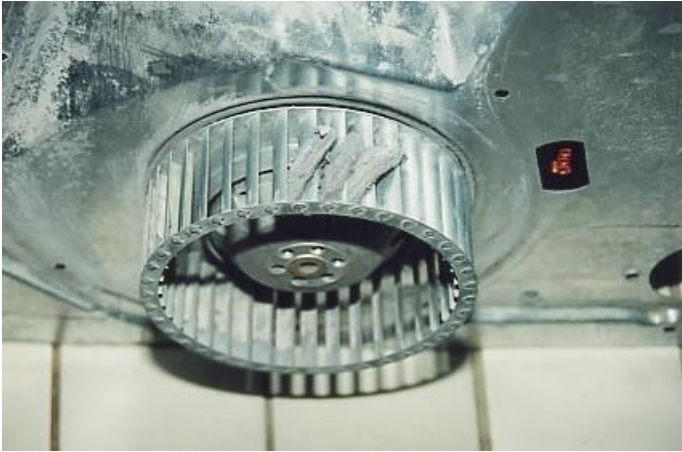
Fläkthjulet med några av de filstavar som återfanns.
