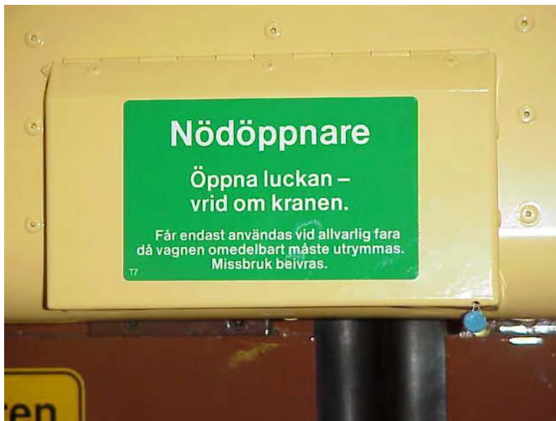
Figur 3. Bild av lucka under vilken nödöppnaren till dörren finns.
