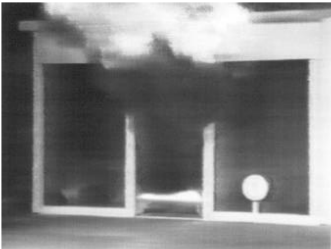
Figur 5.11, När ekvivalenskvoten är lägre brinner flamman längre upp i brandgaslagret.
