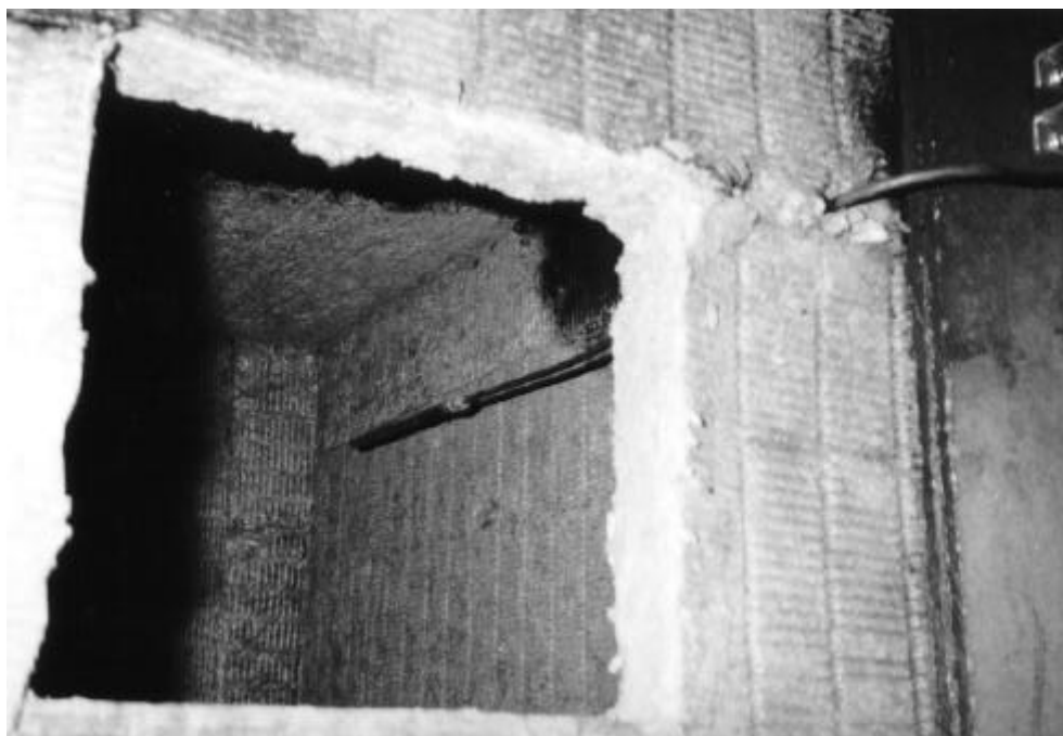
Figur B.3, Probens placering i förbränningskammaren som den var i de flesta försöken. Fotot taget snett underifrån genom öppningen.
