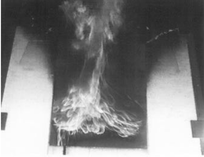
Figur 5.10, När ekvivalenskvoten är hög brinner flamman på undersidan av lagret /5.14/
