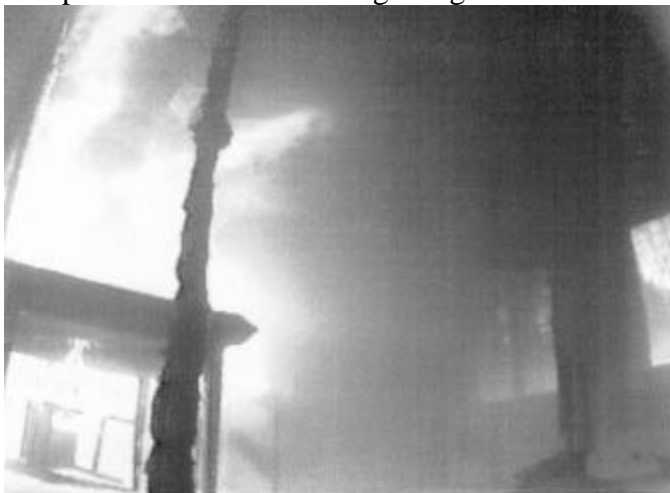
Figur 9.8, Flammor som sprids under taket; övertändningen är nära förestående.
