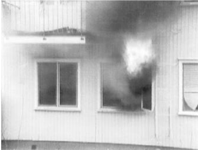
Figur 9.10, Bilden är tagen precis när flammorna slår ut genom rutorna. Rummet är nu på väg att bli övertänt efter ca 300 sekunder.
