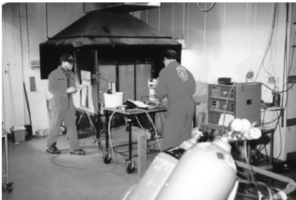
Figur B.1, Försökupställningen för metanförsöken. Förbränningskammaren ses i bakgrunden under huvan och analysinstrumenten till höger.
