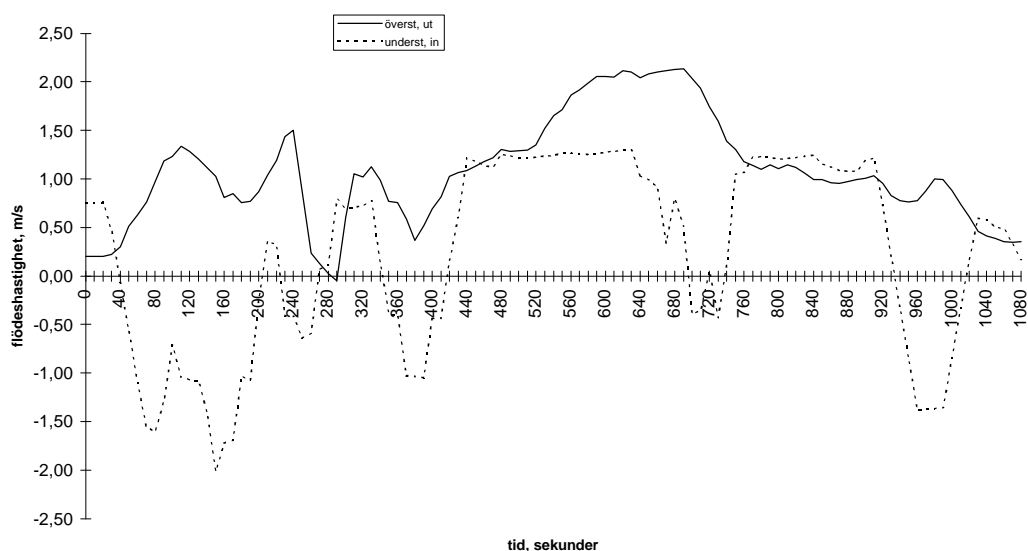
Diagram 10; försök 1c, flödes hastighet genom fönster, utgående brandgas (överst, ut) 0.15m under överkarm samt ingående luft (underst, in) 0.15m över underkarm.
