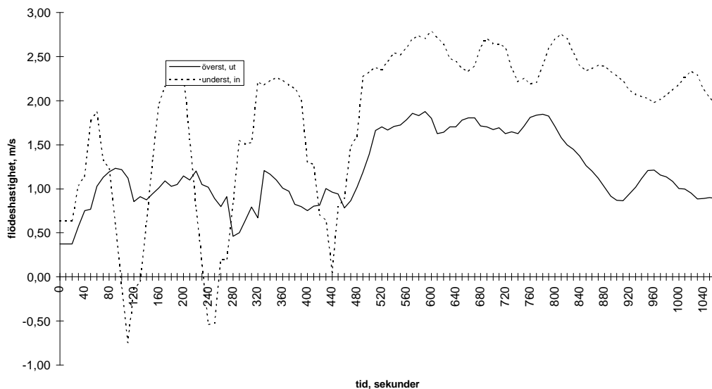
Diagram 6; försök 1b, flödeshastighet genom fönster, utgående brandgas (överst, ut) 0.15m under överkarm samt ingående luft (underst, in) 0.15m över underkarm.
