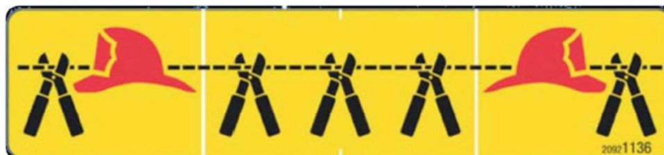
Figur 6. Exempel på etikett för klippning av kabel.
