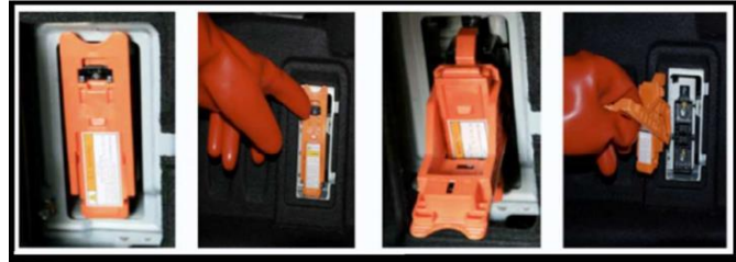
Figur 6. Exempel på strömbrytare för högspänningssystemet.
