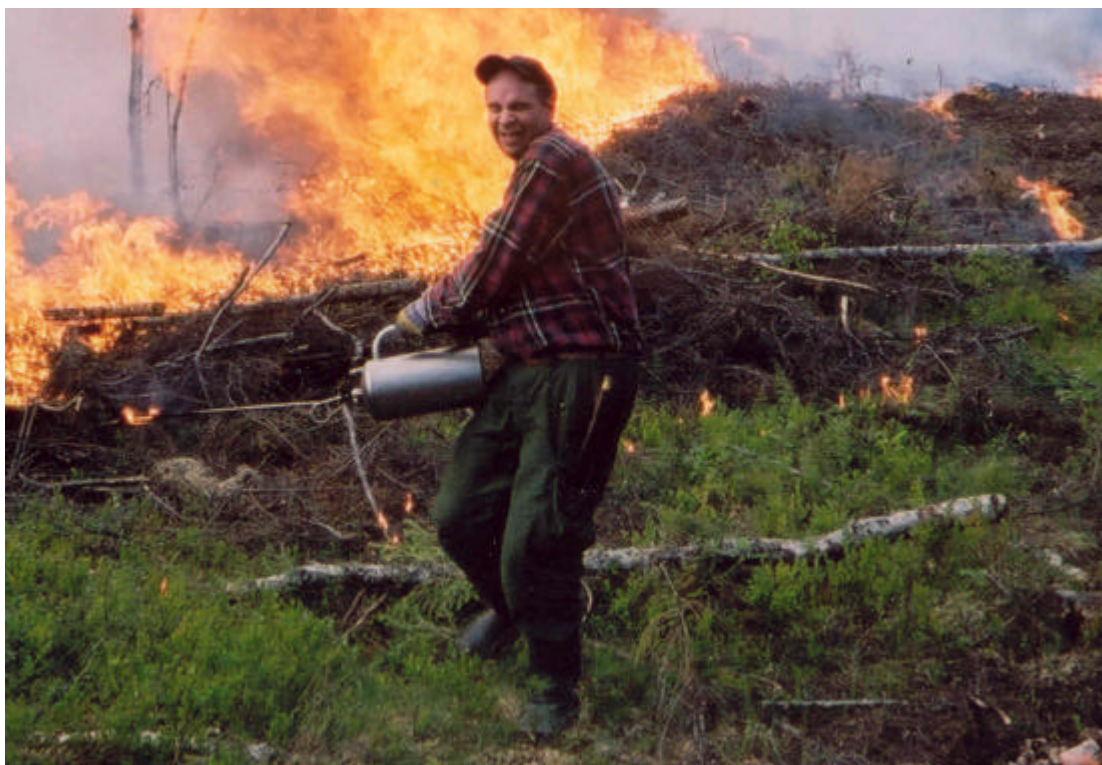
Figur 28. Tändning med "tändkanna", som är ett effektivt instrument för att snabbt anlägga en tändlinje. Kannan är fylld med diesel/bensin (80/20%) eller lysfotogen, och har en ständigt brinnande veke i änden av ett mynningsrör. När man böjer ner röret faller brinnande droppar mot marken och antänder snabbt finbränslet. Observera att bilden inte visar skyddsavbränning.
