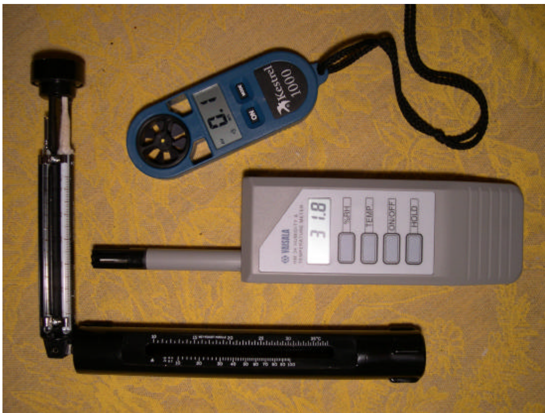
Figur 25. Instrument för fältobservation av vädervariabler som är viktiga för brandbeteende. Nederst en psykrometer för mätning av relativ luftfuktighet. Den har två termometrar varav en har spetsen täckt av en fuktig strumpa. Instrumentet snurras någon minut och temperaturdifferensen mellan torr och våt temperatur översätts till rh via en "räknesticka" på handtaget. Ett alternativ till psykrometern är elektroniska instrument av god kvalitet. Överst en liten handhållen vindmätare.
