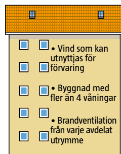
Brandgasventilation av vind.
