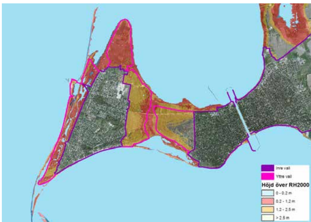
Figur 7. Föreslagen utbredning för yttre respektive inre vällen samt översvämmade områden med respektive nivå då den inre vällen uppförs.
