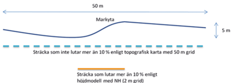
Figur 14. Jämförelse av hur olika noggrannhet i höjdmödel kan påverka utbredningen områden med förutsättningar för skred finns. I bilden visas ett avsnitt som inte detekteras med en lågupplöst höjdmödel.
