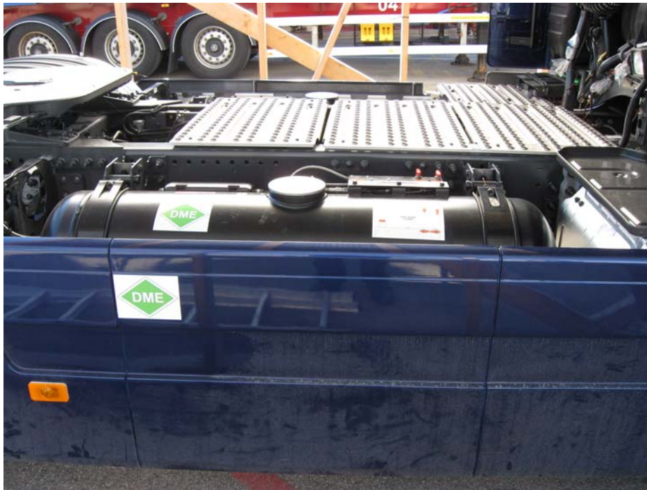
Bild 6, DME-tank monterad på rambalken. En tank på varje sida.
