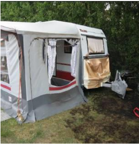
Bägge uppvisar mycket kraftiga skador som är försakat av värmen från branden.
