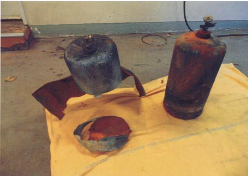
Gasolflaskorna som låg i brandsresterna. Den vänstra har tydliga intryckningsskador i toppen på flaskan. Den högra har skador på gasolvetilen.
