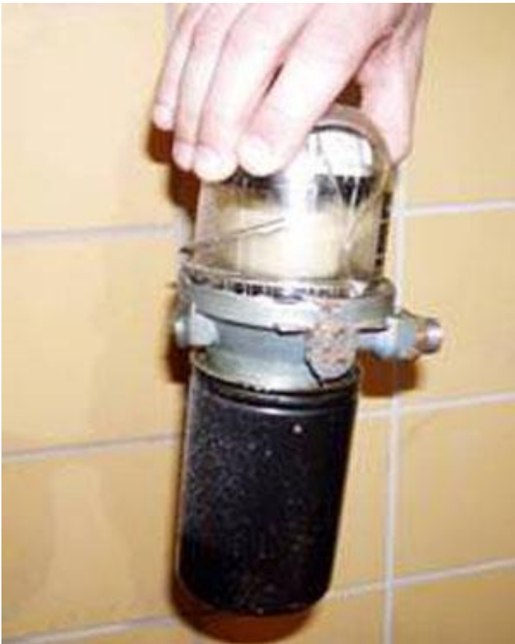
Oljefiltret som har spruckit och gett oljeläckan.
