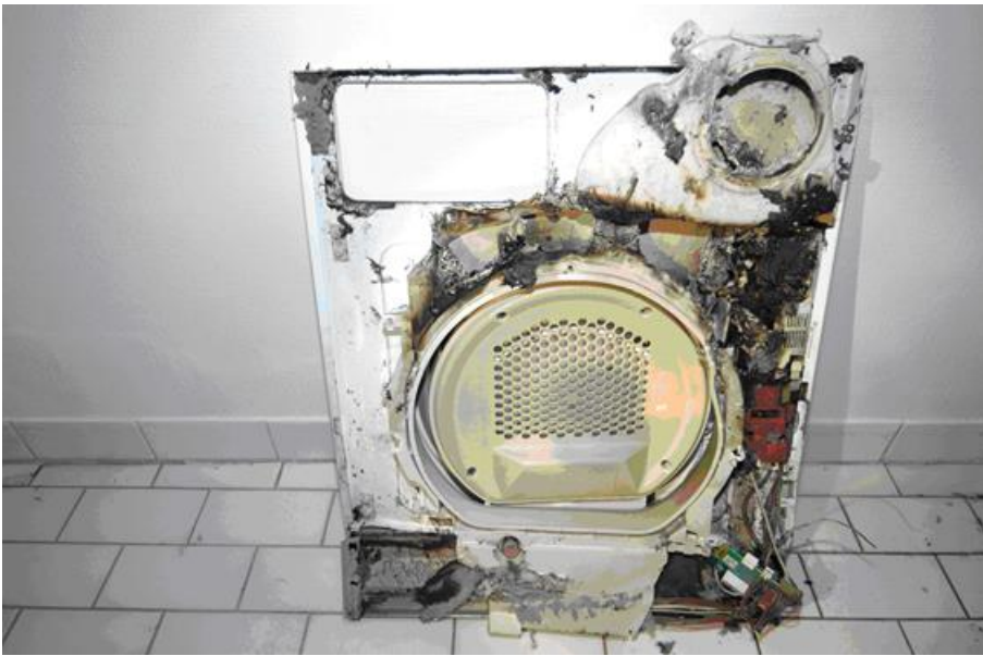
Frontplåten har brandskador som stämmer överens med de största skadorna på maskinen. (står upp och ner)
